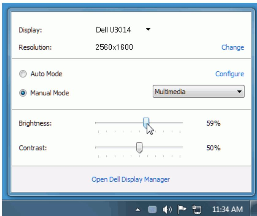
La boîte de dialogue Réglage rapide permet également d'accéder à l'interface utilisateur avancée de Dell Display Manager qui est utilisée pour ajuster les fonctions de base, configurer le Mode auto et accéder aux autres fonctions.
